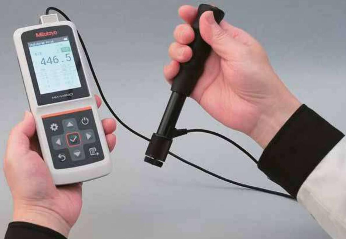
Le HH-V400 est un duromètre de métaux de type à rebond.
