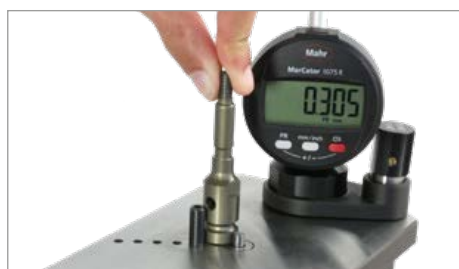
Mesure d'un chanfrein extérieur
