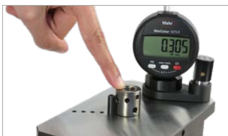
Mesure d'un chanfrein intérieur
