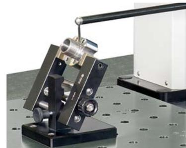
Positionnement flexible de la pièce grâce aux butées de guidage enfichables et à un grand choix de dispositifs de serrage et de supports de pièces standardisés.
