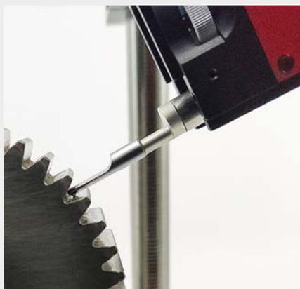
Mesure avec un support de mesure et un palpeur ZH avec patin adapté aux flancs des dents.
