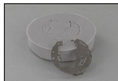
Posage sur mesure en M70 d'une pièce d'horlogerie.
