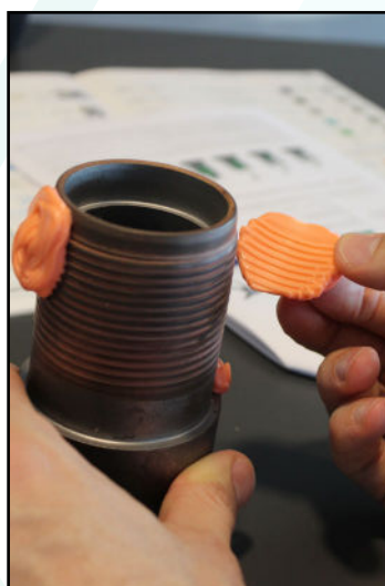
Empreinte externe en P35 coupée au Cutter Double Lame
