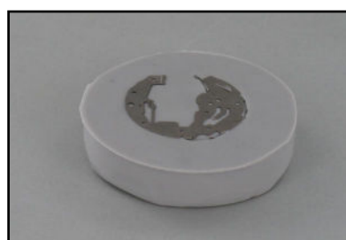
Posage sur mesure en M70 d'une pièce d'horlogerie.
