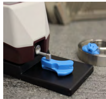
Mesure de rugosité sur une empreinte en P80 Ra
