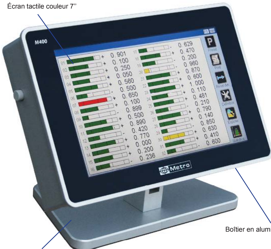
Support orientable (démontable pour installation en panneau)
