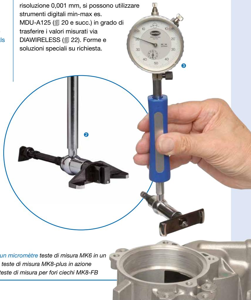
① Etalonnage indicateur MK6 dans un micromètre teste di misura MK6 in un micrometro
