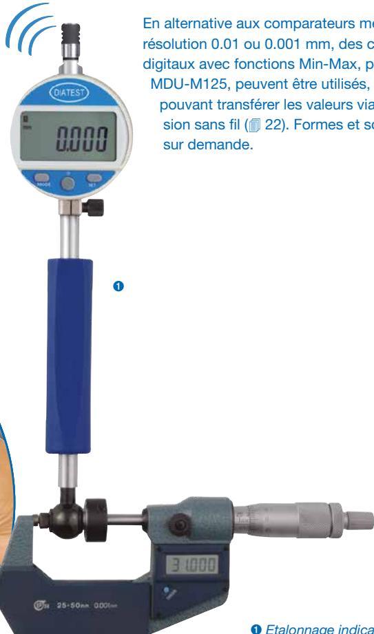
En alternative aux comparateurs mécaniques de résolution 0.01 ou 0.001 mm, des comparateurs numériques avec fonctions Min-Max, par exemple MDU-M125, peuvent également être utilisés, ces derniers pouvant transférer les valeurs via une transmission sans fil (§ 22). Formes et solutions spéciales sur demande.
