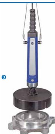
Des comparateurs mécaniques ou numériques, le DIATRON1000, des capteurs analogiques MTD reliés à une colonne DIATRON2200 (§ 20 et suivantes.) peuvent être utilisés pour afficher les valeurs. Le tampon BMD multi-plans DIATRON- MultiFire (§ 20) peut être intégré dans un réseau sans fil.
