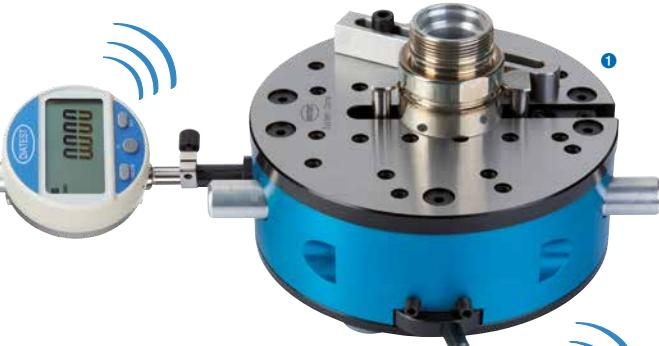
1 Table de mesure 2-points C2 2-punti tavolino di misura C2 2. Table de mesure 3-points C3-AL 3-punti tavolino di misura C3-AL 3. Table de mesure 2-points C2-JS 2-punti tavolino di misura C2-JS
