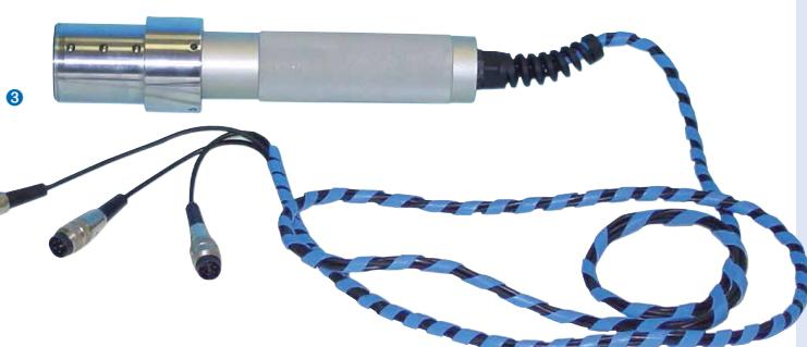
① *Module radio sur DIATRON1000 Radio modulo su DIATRON1000* ② *Récepteur radio, PC portable avec DIA-EXDLL* Radio ricevitore, laptop e software DIA-EXDLL ③ *Tampon multi-diamètre avec capteurs MTD* Tampone multipiano con sonde HBT
