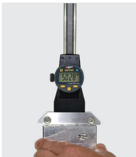
Mesure d'une profondeur
