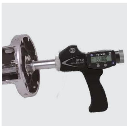
Mesure avec système XT3H à pistolet
