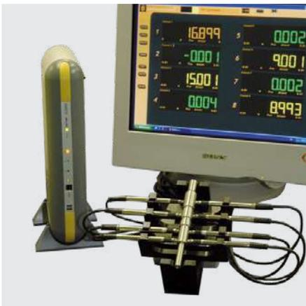
Mesure en dynamique des différents diamètres d'un axe et de leur concentricité
