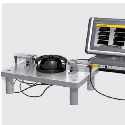
Affichage multi-canaux en simultané par l'intermédiaire du multiplexeur D200S pour mesure multi-cotes
