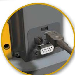
Sortie câble RS232 sur USB (925-1142) ou RS232 (925-5609) ou sortie câble mini-USB sur USB (926-6001)
