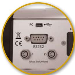
Sortie câble RS232 sur RS232 (926-5609) ou USB (925-1142) ou sortie câble mini-USB sur USB (926-6001)
