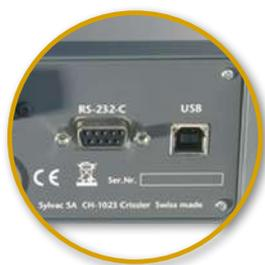
Sortie câble USB sur USB (804-1210) ou sortie câble RS232 sur RS232 (925-5609)
