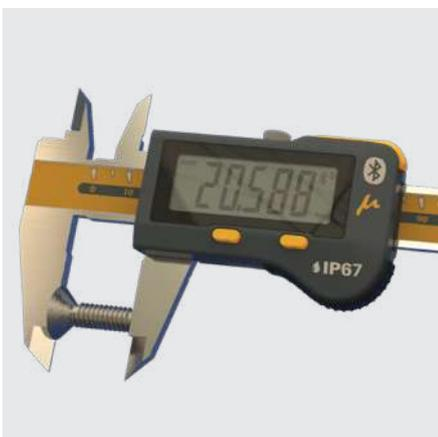
Mesure d'une pièce avec S\_Cal  $\mu\text{m}$
