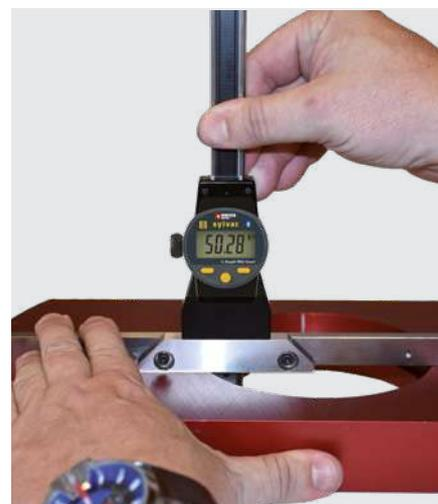
Mesure de profondeur dans un grand alésage grâce aux ponts additionnels
