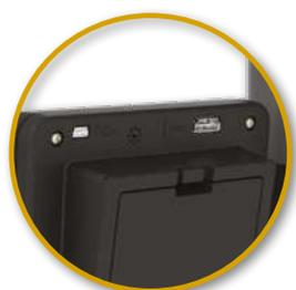
Sortie câble RS232 sur RS232 (926-5505) ou sortie câble mini-USB sur USB (926-6001)
