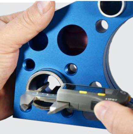
Mesure profonde avec S\_Cal EVO Smart DM
