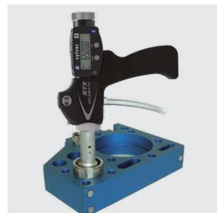
Mesure avec système XT3H à pistolet
