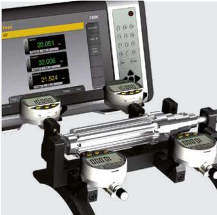
S\_Dial WORK Smart communiquant en duplex avec une unité D300S. Mesure de diamètres extérieurs, concentricité, cylindricité, etc.
