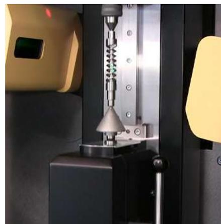
Mesure d'un filetage avec SCAN F60T
