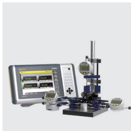
Connexion de comparateurs avec technologie sans fil Bluetooth® sur D300S.
