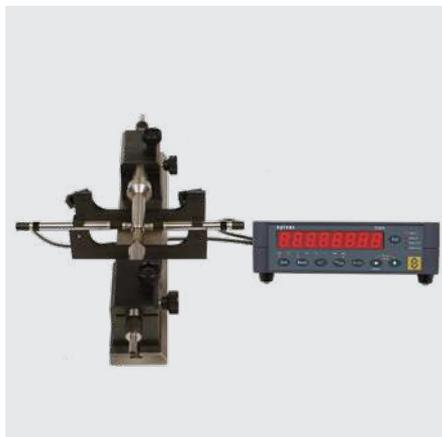
Mesure d'un axe avec 2 palpeurs (A+B)
