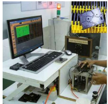
Mesure multi-cotes de la planéité de bases de disques durs
