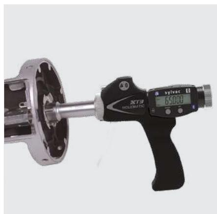
Mesure avec système XT3H à pistolet
