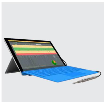
Palpeur P12D USB connecté à un PC. Mesures affichées sur le logiciel Sylcom.
