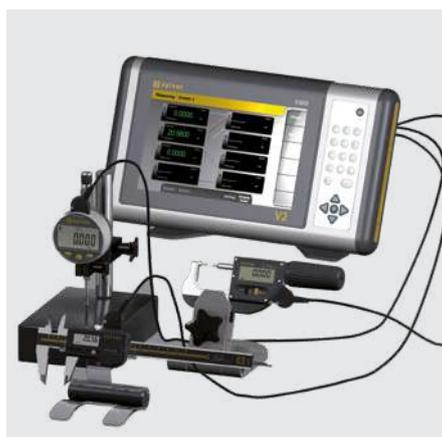
Connexion multiple d'instruments à main avec affichage des tolérances
