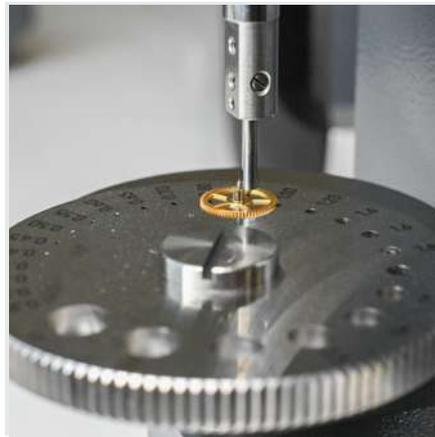
Mesure de petites pièces avec PS15BV+ et table rotative à 25 trous
