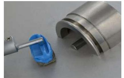
Contrôle de rugosité Ra
