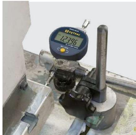
Mesure du déplacement vertical d'un élément
