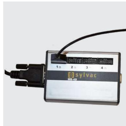
Instruments digimatiques connectés à un module MB-4D
