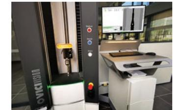
Mesure par scan optique
