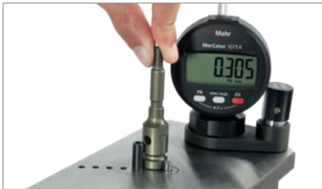
Mesure d'un chanfrein extérieur
