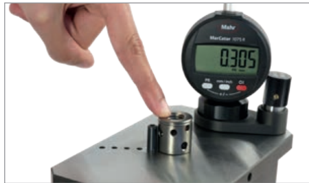
Mesure d'un chanfrein intérieur
