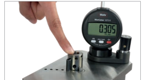
Mesure d'un chanfrein extérieur
