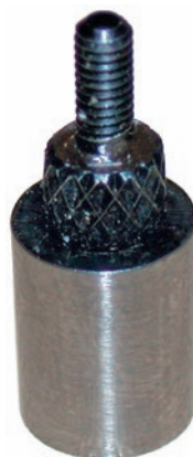
Touché cylindrique calibrée, pour mesure de plan de jauge.
