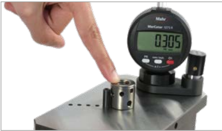
Mesure d'un chanfrein intérieur
