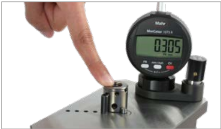
Mesure d'un chanfrein extérieur
