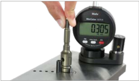
Mesure d'un chanfrein extérieur
