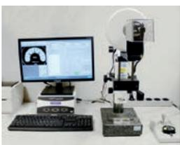
Étalonnage comparateur avec système caméra
