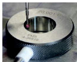
Étalonnage bague lisse sur banc SIP
